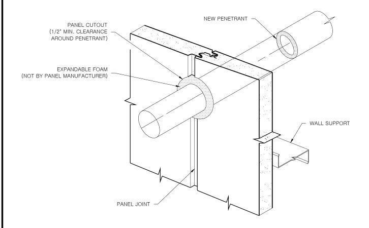
NEW PENETRATION IN EXISTING WALL AT PANEL JOINTS
