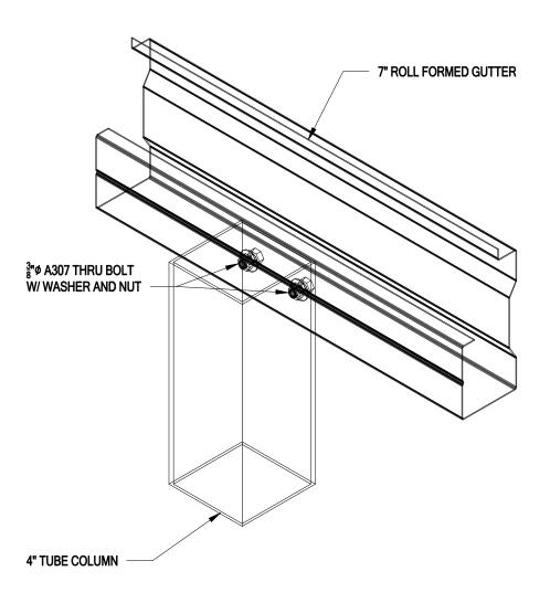
4" TUBE TO ROLL FORMED GUTTER
