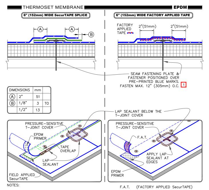
1. HP FASTENERS AND POLYMER SEAM PLATES ARE REQUIRED OVER STEEL DECKS.
