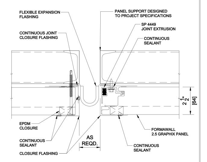
**DETAIL 9a**2.5G EXPANSION JOINT - FLASHING
