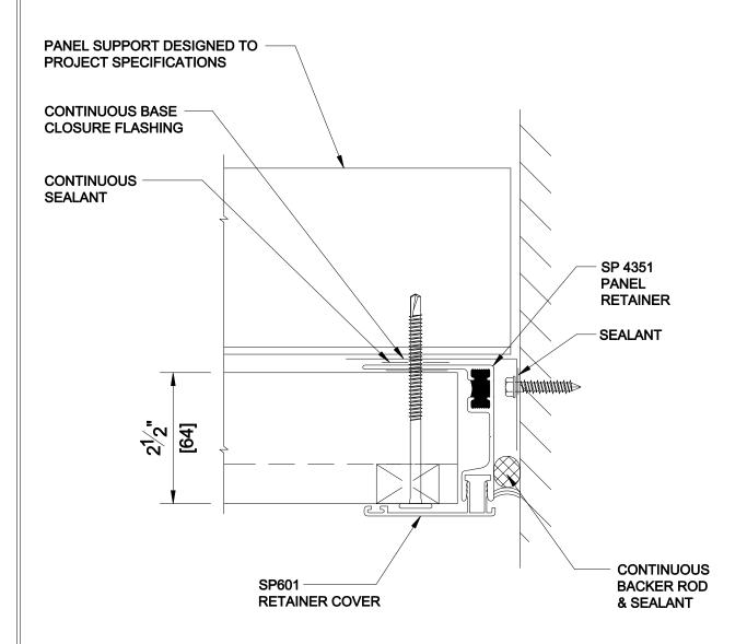
**DETAIL 3**2.5G END WALL - OFF MODULE - EXTRUSION
