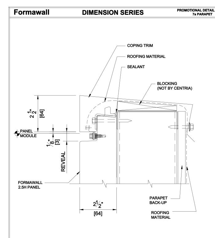
**DETAIL 7a** 2.5H PARAPET - FORMED METAL
