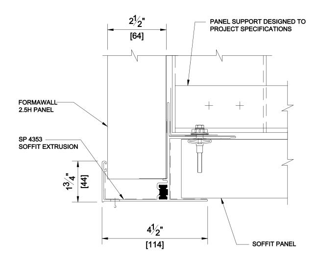
**DETAIL 8b**2.5H SOFFIT - FRONT - OFF MODULE
