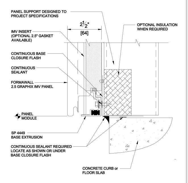
**DETAIL 3**2.5G IMV BASE - AT SLAB - ON MODULE
