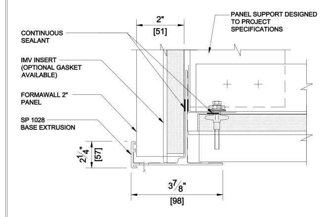
**DETAIL 8b**2H CUT PANEL SOFFIT
