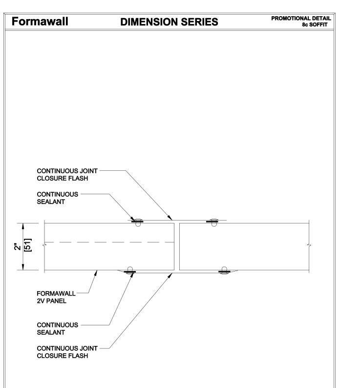
**DETAIL 8c** 2V SOFFIT - OS CORNER OR IS CORNER
