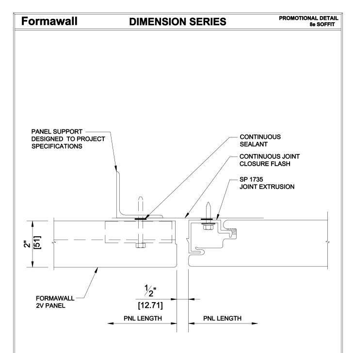
**DETAIL 8e**2V SOFFIT - EXTRUDED - SIDE WALL RETURN
