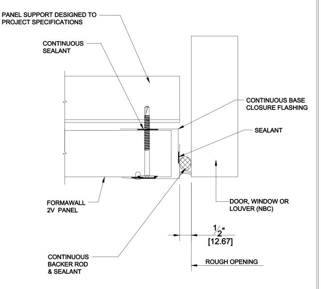
**DETAIL 5b** 2V JAMB - FLASHING
