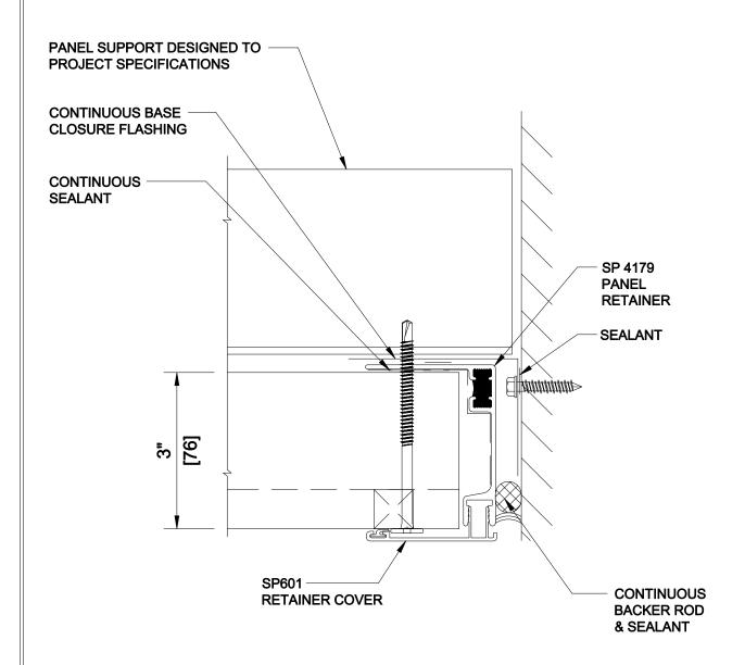
**DETAIL 11**3"-TG END WALL - OFF MODULE - EXTRUSION
