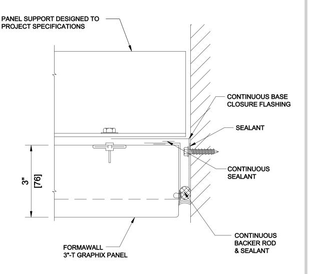
**DETAIL 11b** 3"-TG END WALL - OFF MODULE - TRIMLESS
