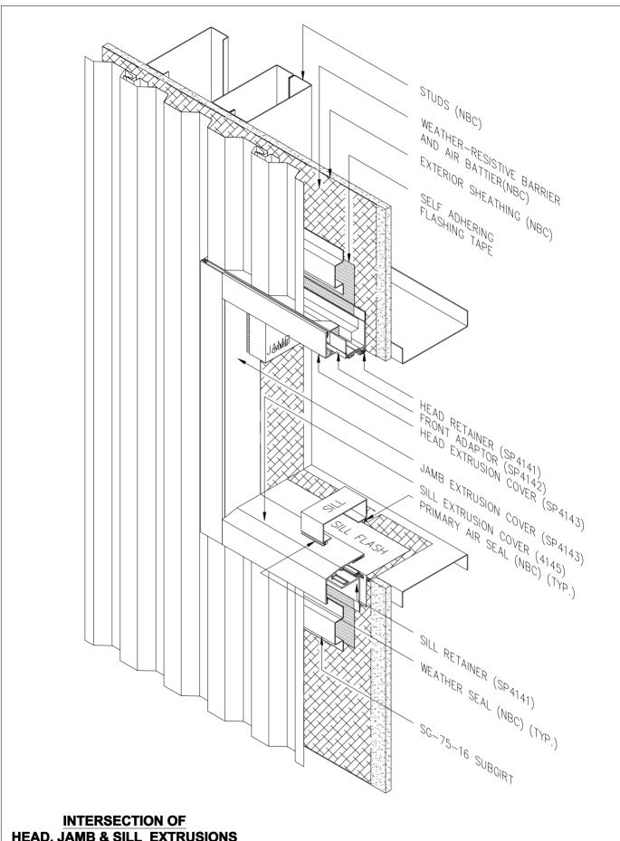
**HEAD, JAMB & SILL EXTRUSIONS** (CS-7513)
