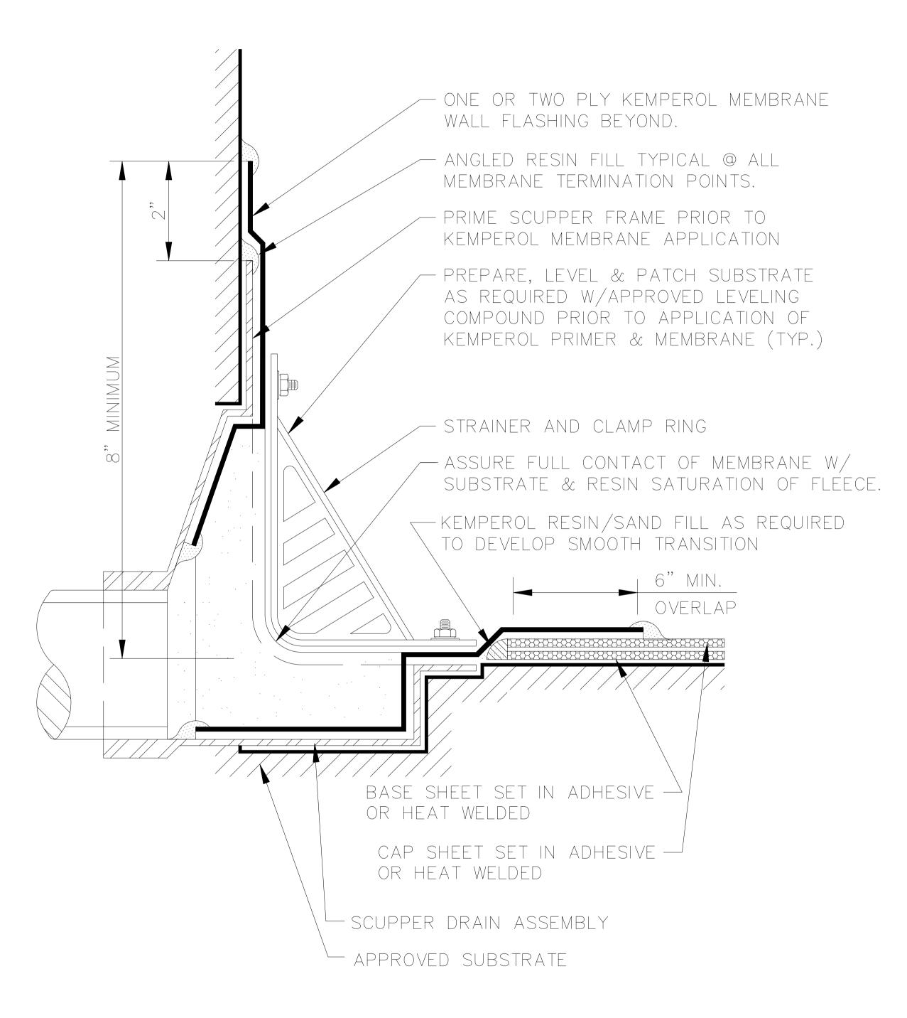
NOTE: KEMPEROL FLASHING MEMBRANE MUST EXTEND 6" MIN. HORIZONTALLY ONTO MODIFIED BITUMEN MEMBRANE.
