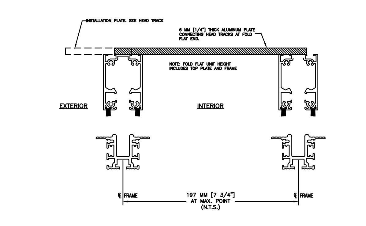
S TYPICAL PLAN VIEW OF HEAD TRACK AND SILL LAYOUT AT THE END OF FOLDFLAT UNIT
