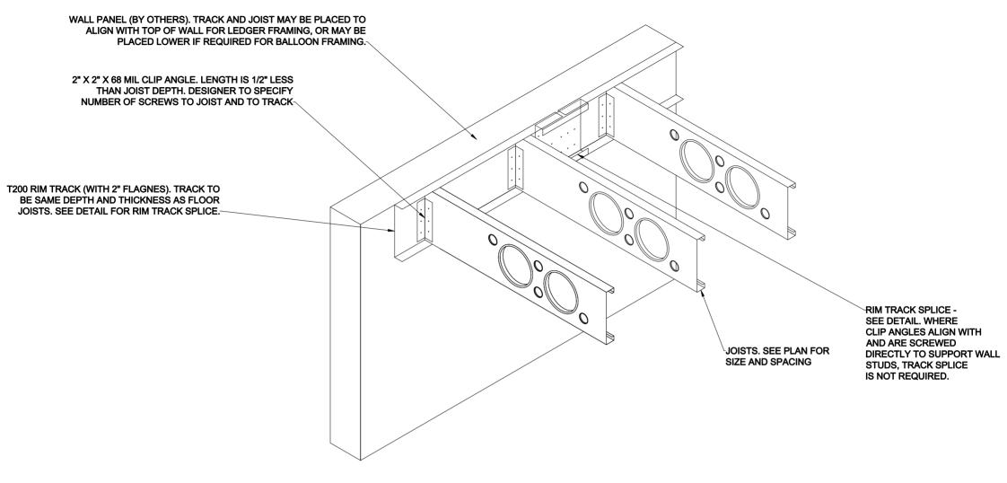
JOIST TO FACE OF WALL PANEL
