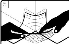
ROLL & CREASE FLASHING TIGHTLY INTO ANGLE CHANGE & FIRMLY ROLL FLASHING ONTO THE DECK MEMBRANE
